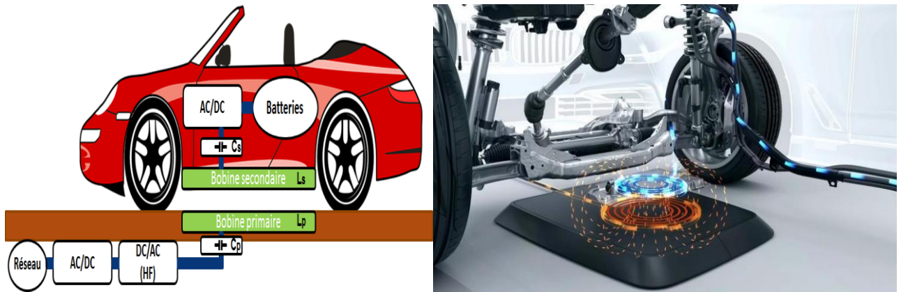
Fig.I.10 Système de charge par induction d'une voiture
