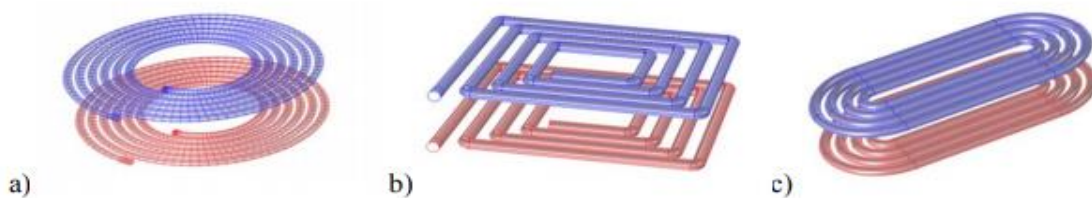
Fig.II.5 Formes des bobine de CI: a) Circulaire, b) Carrée et c) Elliptique
