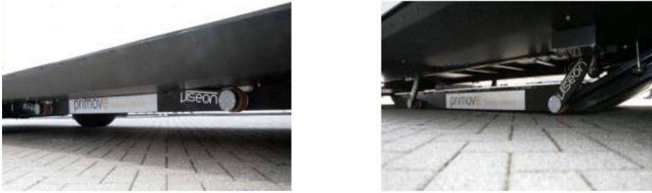
Fig.I.12 Secondaire du système Primove développé par Bombardier, (a) Secondaire pendant le déplacement, (b) Secondaire abaissé lors de la recharge [4]
