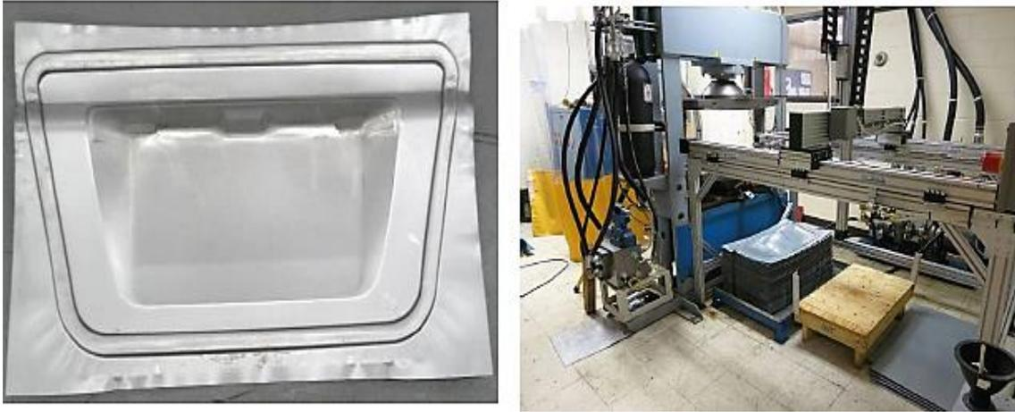
**Figure I.10: Plaque d'immatriculation et cellule automatisée pour sa production**
