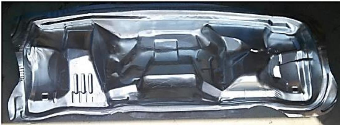
**Figure I.13 : Le tableau de bord entièrement formé par FEH**
