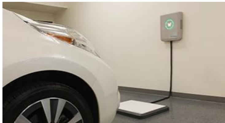
Figure II.4 : Système WPT de Witricity, source [12]
