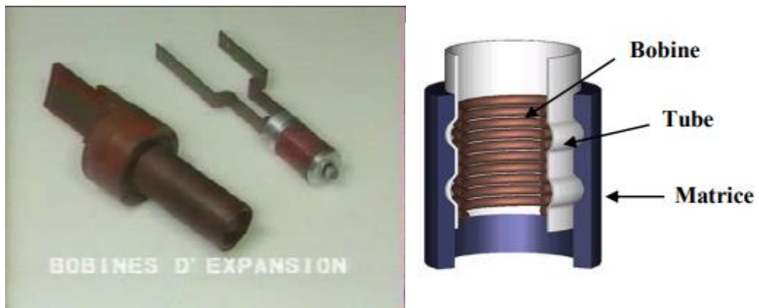
Figure I.6 : bobines d'expansion de tubes
