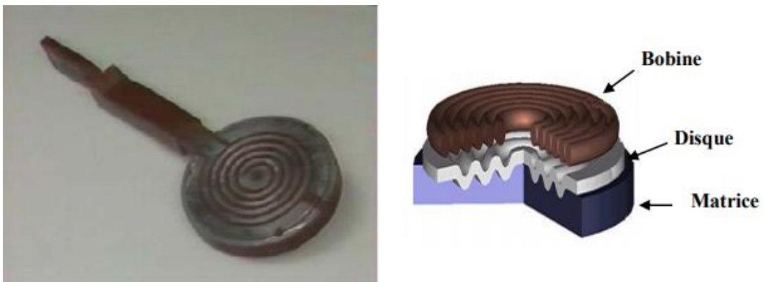
Figure I.5 : Bobines d'emboutissage des tôles métalliques
