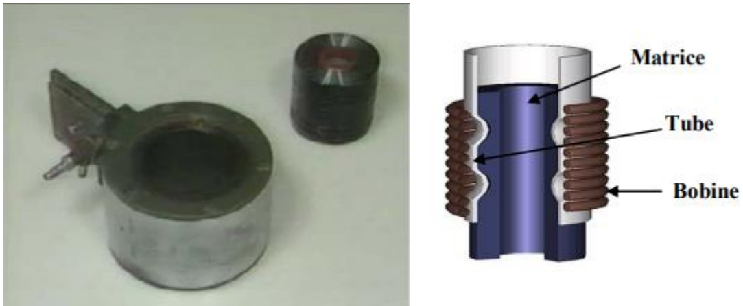
Figure I.7 : bobines de Compression de tubes
