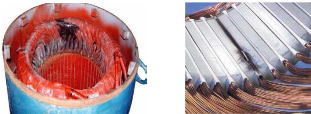
Figure I.13. Exemple de dégâts provoqués par les défauts de court-circuit statoriques
