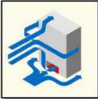
FIGURE 3.12 : Effet de passage sous immeuble. (source : Gandemer 1975)
