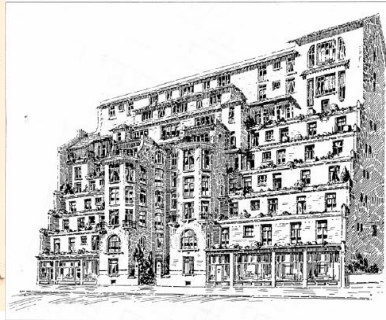
Figure 1.15 : Adaptation aux contraintes solaires. (L'immeuble en gradin, à Paris H. sauvage, 1912)
