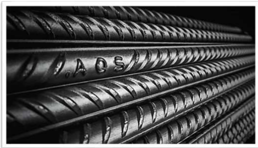
Figure I.10 : Rond à béton.
