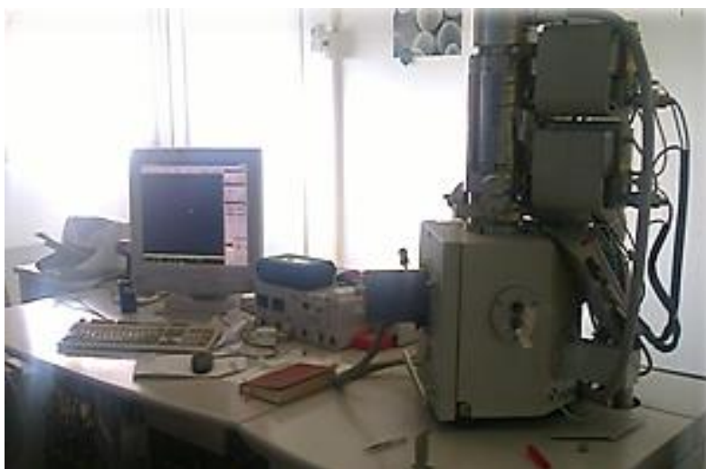
Figure II.4 : Microscope électronique à balayage de type ESEM XL 30 FEG Philips de CRNA.
