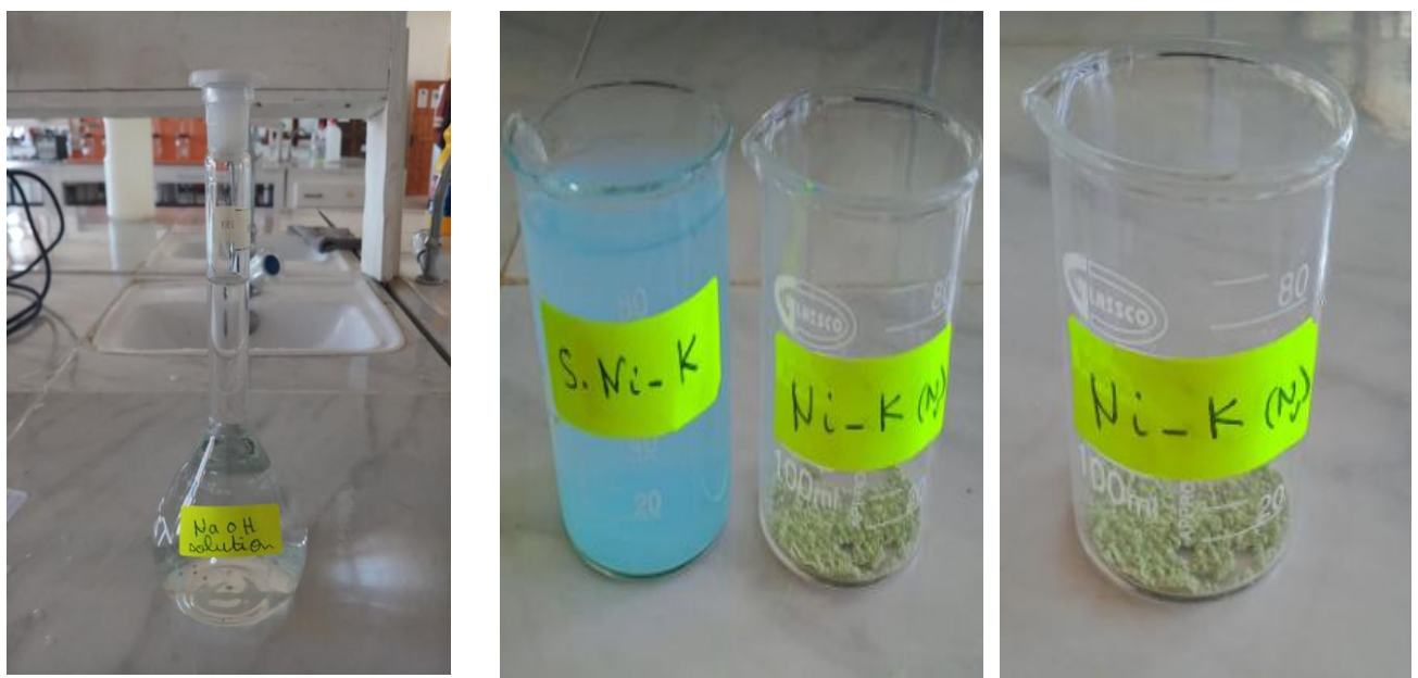
Figure II.18: Les étapes de la préparation du Kaolin (prétraité par NaOH) échangé par Ni .
