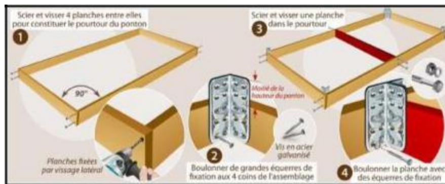
Figure 43 :Assemblage du cadre du ponton
