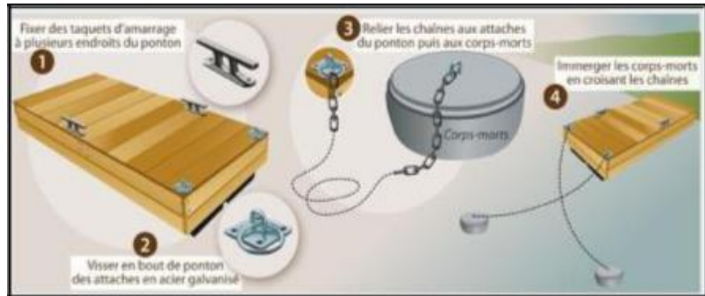
Figure 46 : Fixation du ponton flottant
