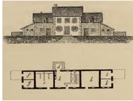
Figure06 : Plan et élévation d'une ferme à un seul corps de bâtiment. Source : Bouchard-Huzard, Louis. Traité des constructions rurales. Ed 1, 1982, P624.
