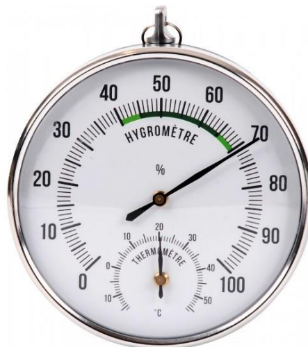
Figure 16: Hygromètre à mèche cheveu, Source: www.monmagasinegeneral.com (consulté le 22/05/2021)
