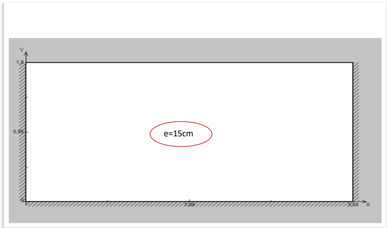
Figure.III.18. Schéma du balcon encastrés sur trois côté.
