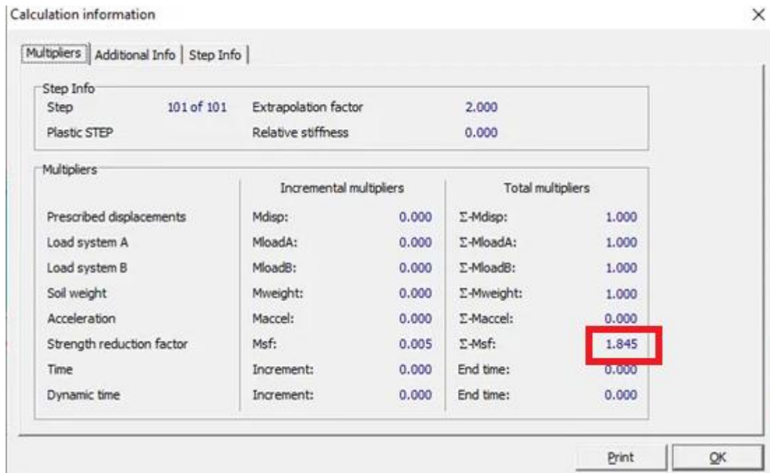
Figure VI.11: Coefficient de sécurité du talus après confortement.
