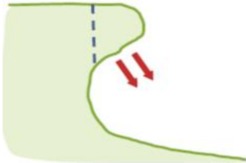
Figure I.2: Schématisation du phénomène d'éboulement. [4]
