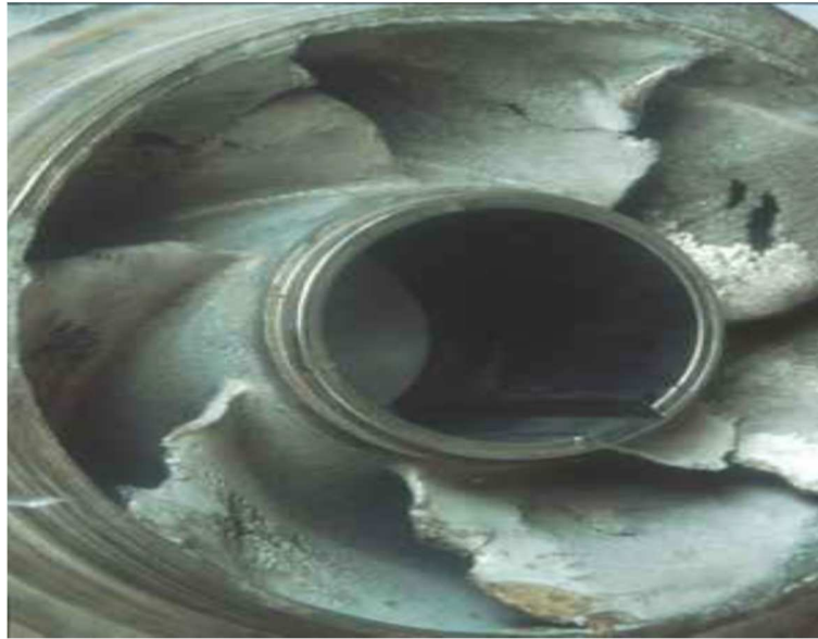
Figure (V.5) : Photo illustrant le phénomène de cavitation sur des aubes d'une pompe centrifuge.
