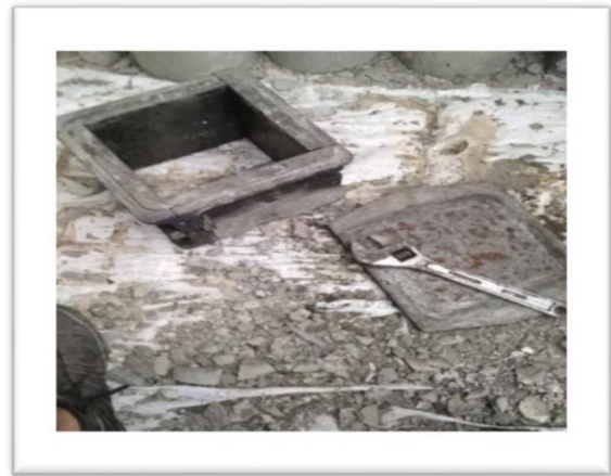
Figure14, 15/CH2 : Préparation des moules avant le remplissage.
