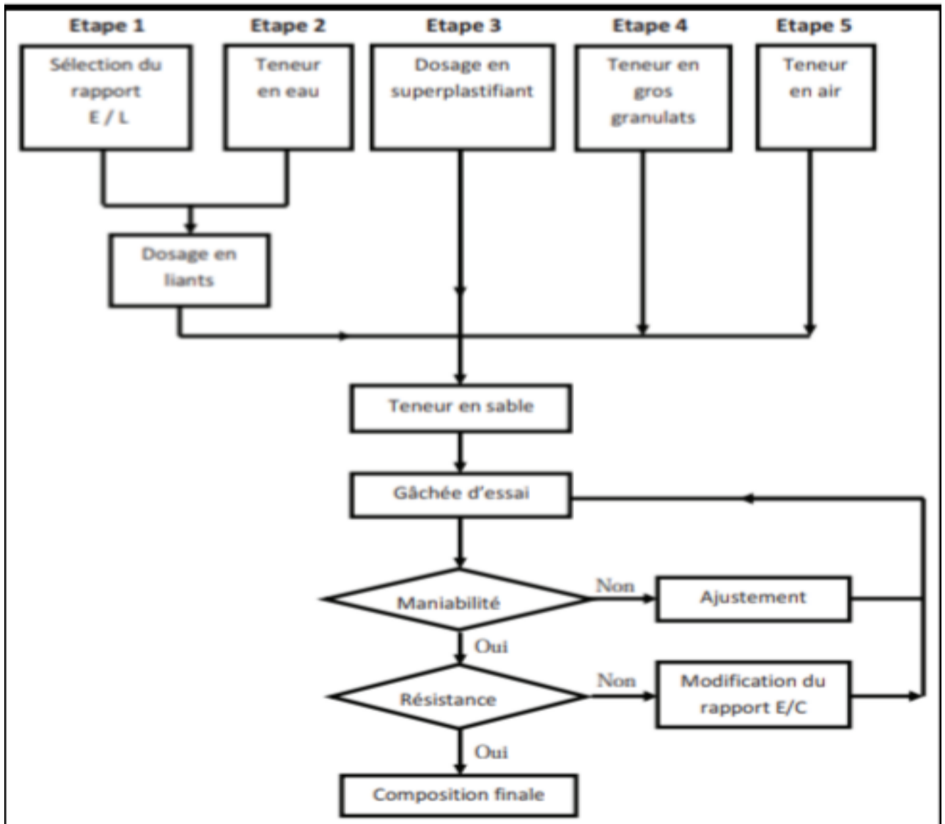
Figure7/CH2 : La méthode de formulation de l'université de Sherbrooke
