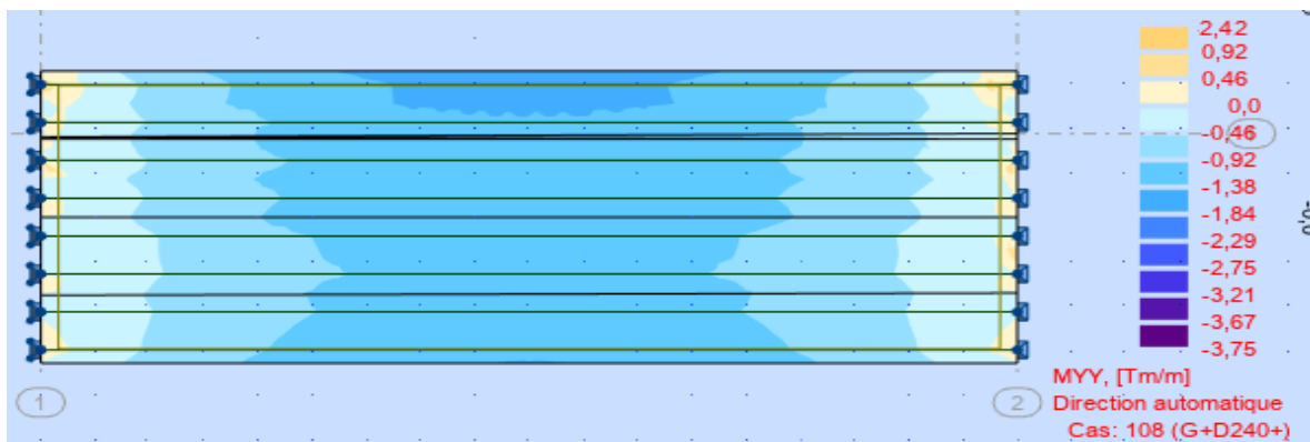
Figure.IX.4 : Distribution du moment fléchissant longitudinal sur la dalle (ELS).
