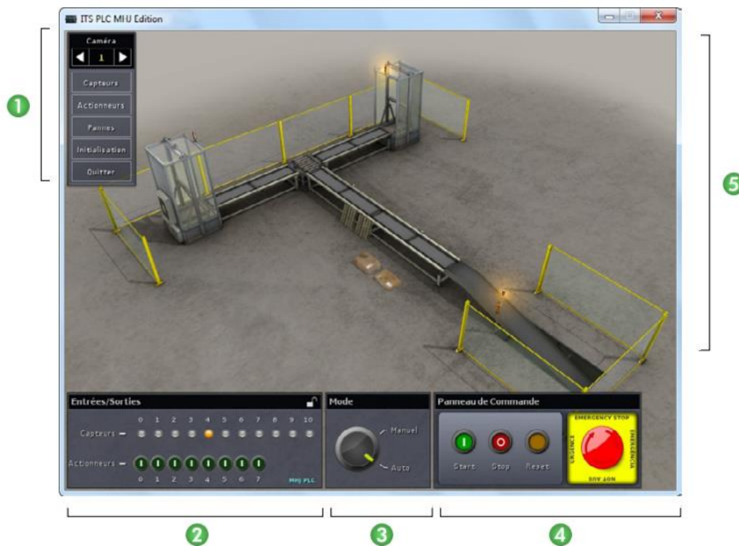
Figure 3.4: Panneaux du système (1- panneau utilitaire, 2- panneau des E/S, 3- panneau choix du mode, 4- panneau de commande).
