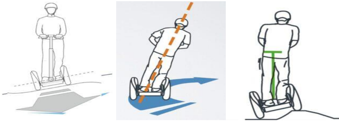
Figure (I-4): Principe de fonctionnement du Segway - pour tourner
