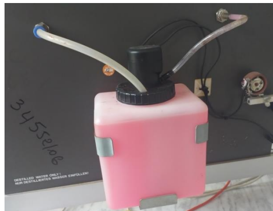
Figure II.2 : Réservoir de stockage
