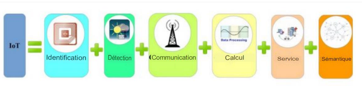
Figure 1.3 : les éléments de l'IoT
