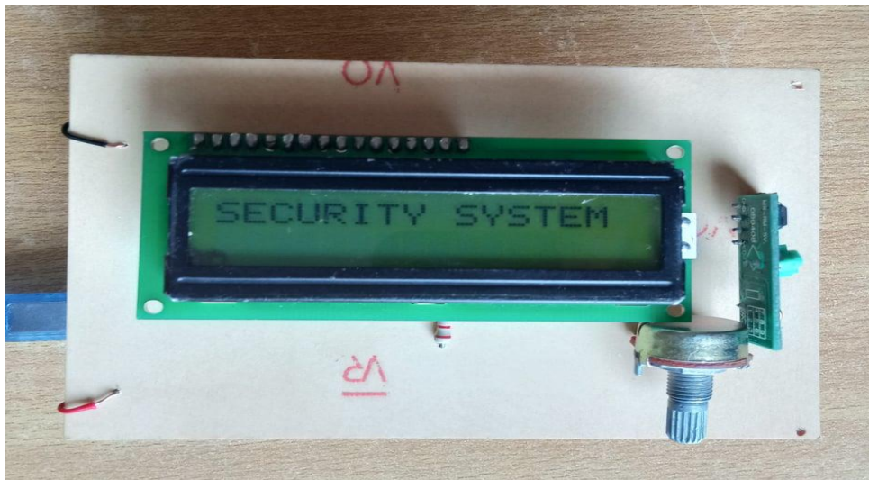
Figure 4.23 : Message du test I déchiffré affiché sur LCD.
