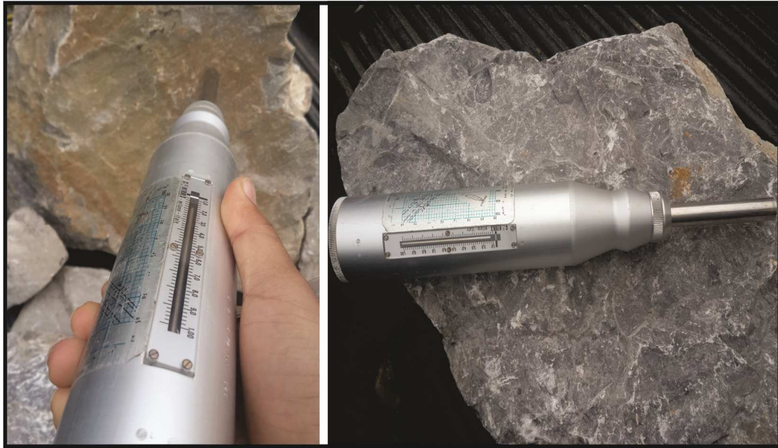
Fig. III.09 : Appareillage de scléromètre.
