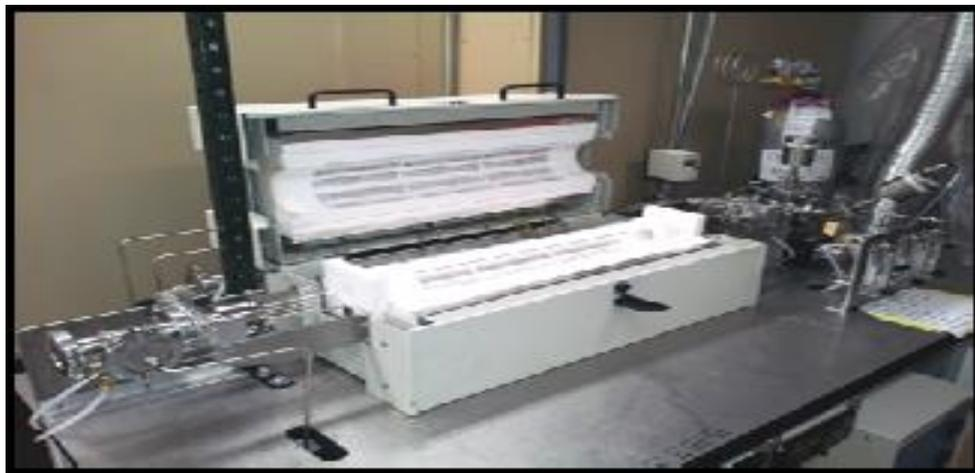
**Figure I.19.** Schéma et photographie d'une chambre CVD [41].
