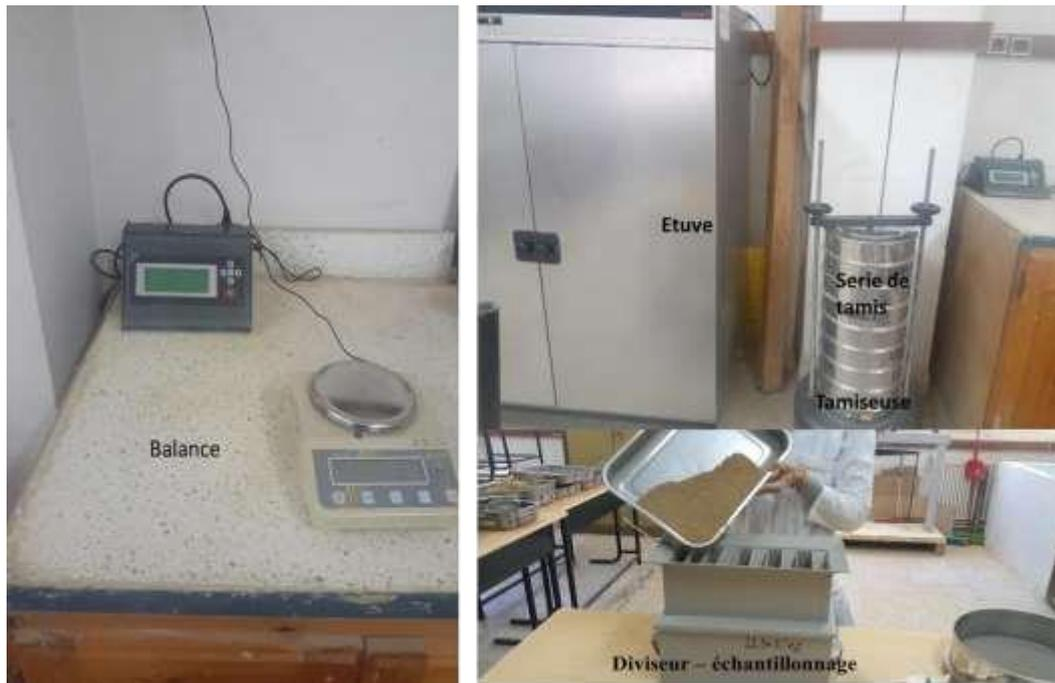
Fig.IV.1- Equipements utilisés dans l'opération de tamisage des échantillons phosphatés.
