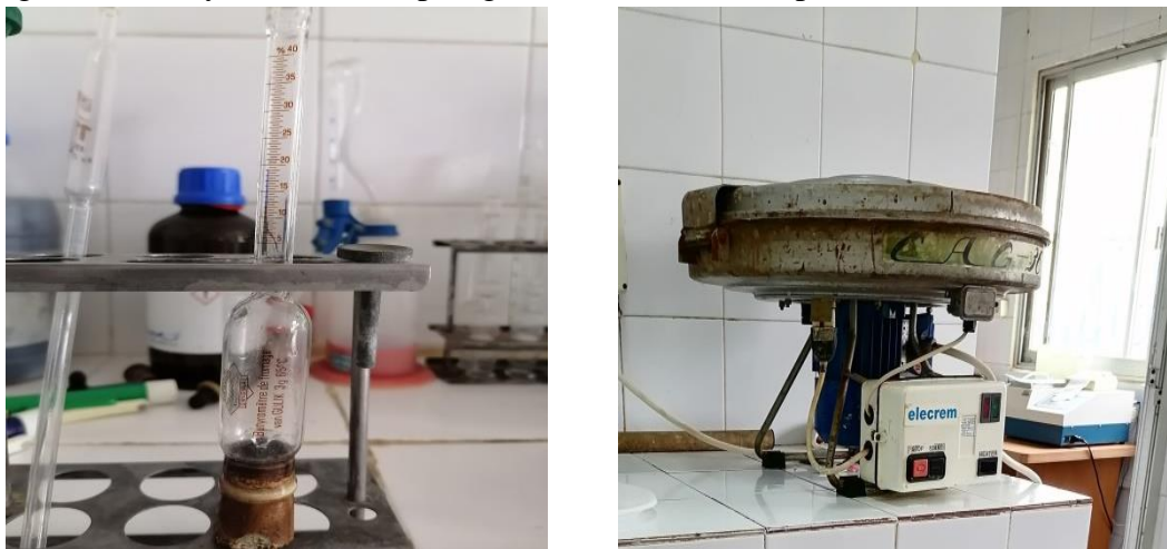
Figure 05 : Butyromètre et centrifugeuse de séparation de la matière grasse.
