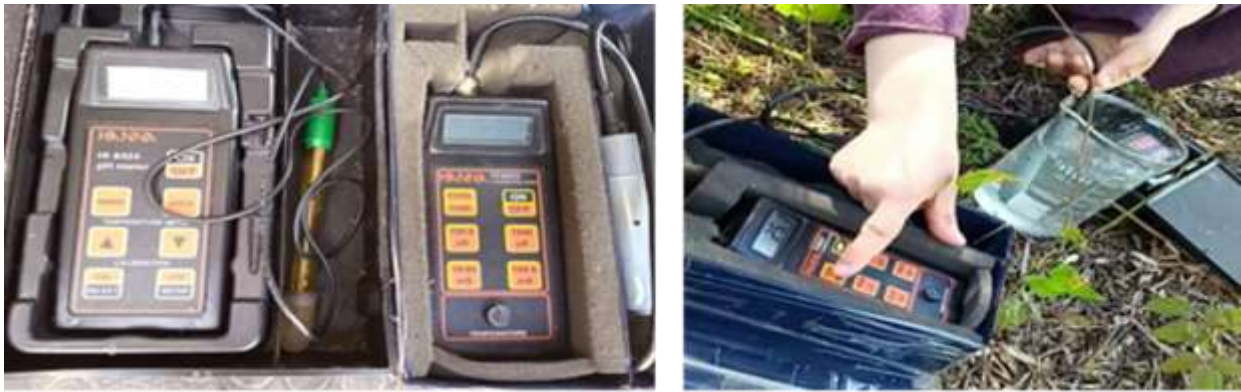
Photo.7 : Les appareils utilisés pour mesurer pH et CE
