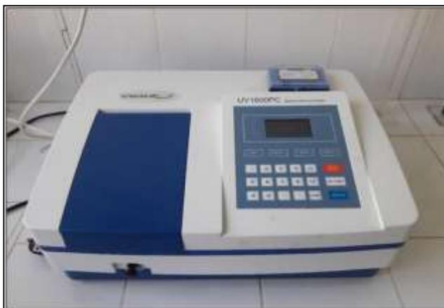
*Photo III.4 : spectrophotomètre (VWR - UV 1600 PC).*
