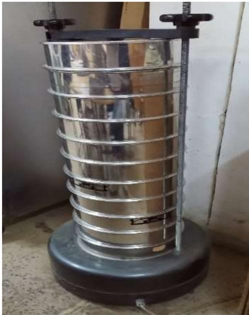
**Fig.II.16.** Tamiseuse avec série de tamis emboîtés
