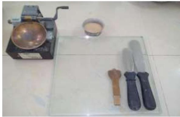
**Fig.II.19.** Dispositif d'essai de limite de liquidité
