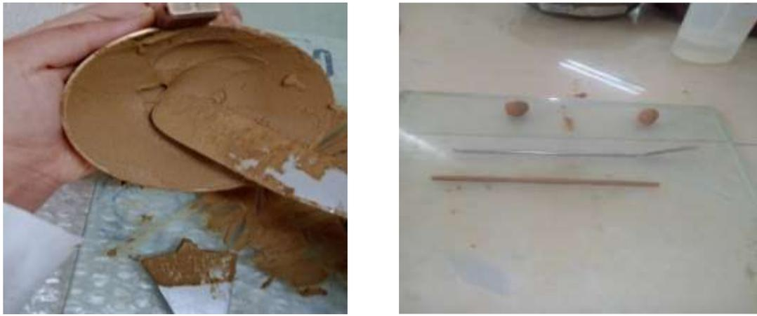
**Fig.II.20.** Détermination des limites d'Atterberg.
