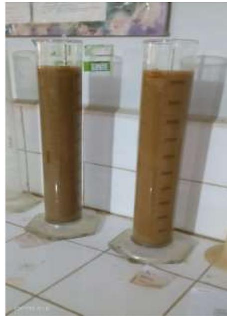
**Figure II.17.** Eprouvettes d'analyse granulométrique par sédimentation
