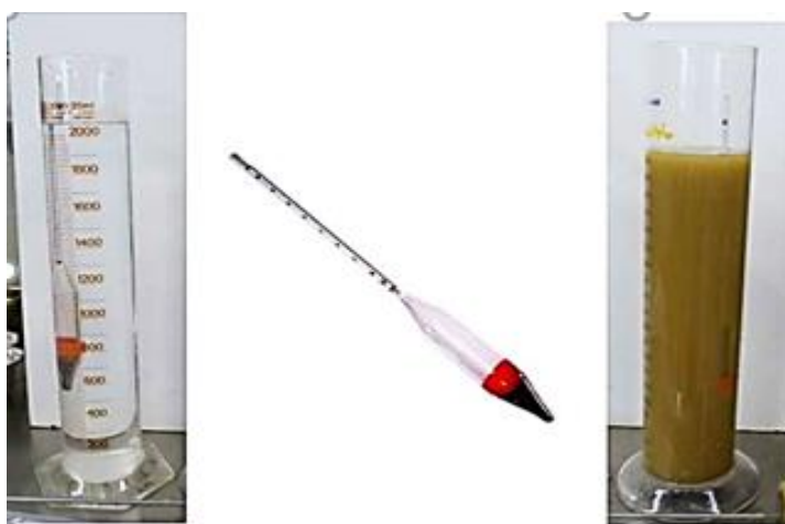
Figure III.6 : analyse granulométrique par sédimentation
