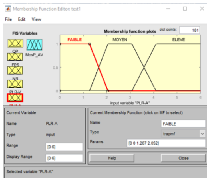
FIGURE 4.11 – Fuzzification de la variable d'entrée PLRV
