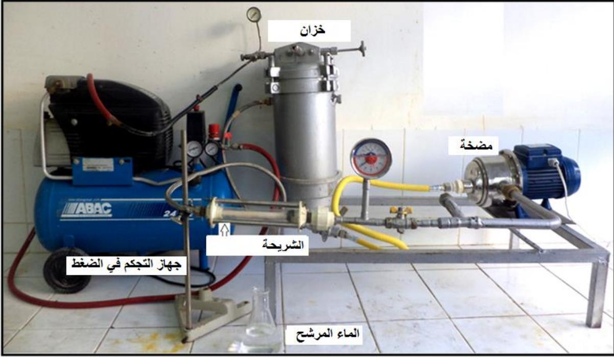
الشكل (8-II): تركيبة اختبار النفاذية.
