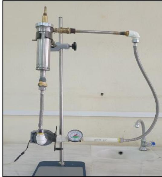
الشكل (9-II): جهاز الترشيح.
