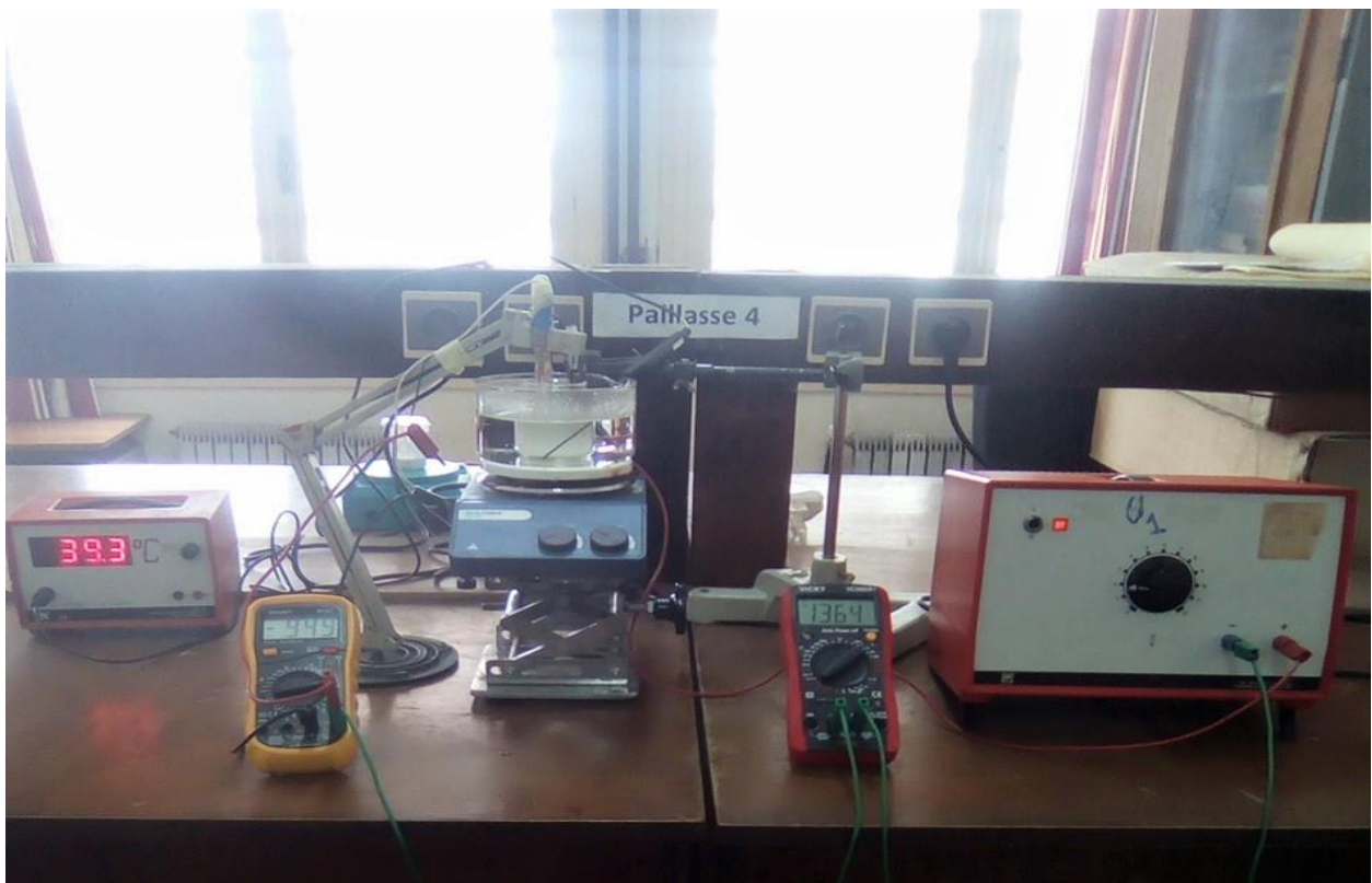
Figure. II.8. Dispositif expérimental du montage de l'électrodéposition à trois électrodes.
