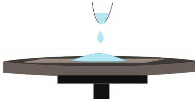
Figure II.7 Dépôt de la goutte.
