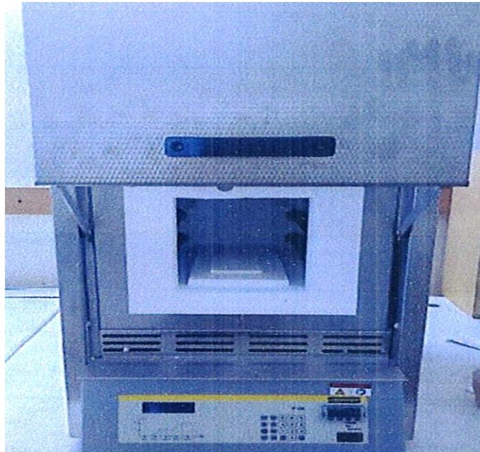
Figure III.5 Four utilisé pour le recuit.
