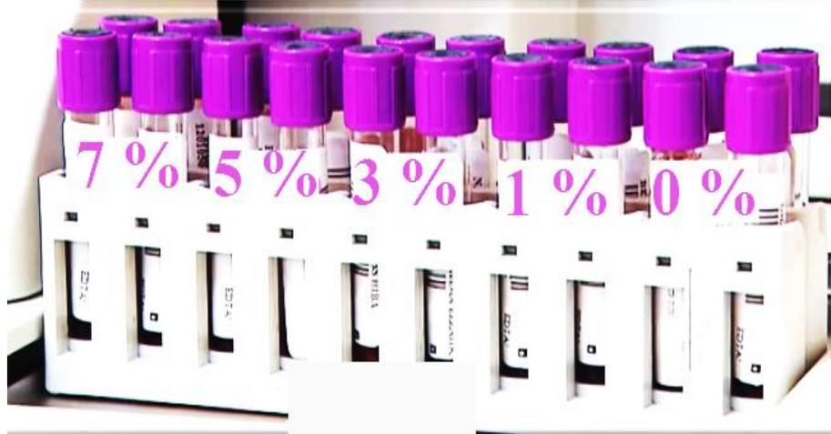
Figure III.2 Solutions préparées d' $Y_2O_3$  pur et dopées.
