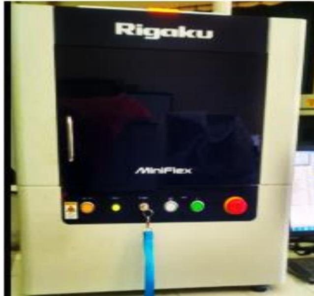
Figure II.15 Diffractomètre de rayons X type Rigaku Mini Flex.
