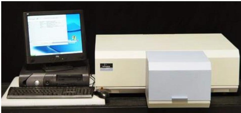
Figure II.21 Spectrophotomètre de luminescence-fluorescence (PL).
