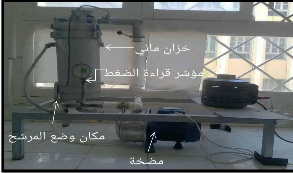
الشكل (II-9): صورة لجهاز اختبار النفاذية.
