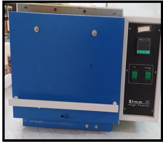
الشكل (II-6): صورة الفرن الكهربائي a و b.
