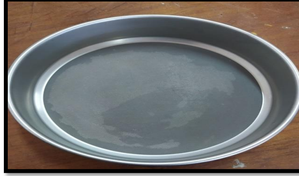
الشكل (II-3): صورة للغربال المستخدم قطر مساماته 160\mu\text{m} .
