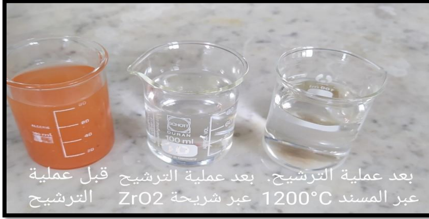
الشكل (III-19): عينات من الماء المعكر قبل وبعد عملية الترشيح.
