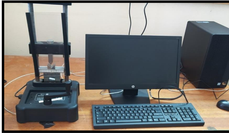
الشكل (II-8): صورة لجهاز إختبار الثني.
