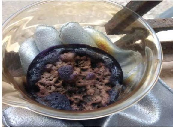
Figure III.2: Agglomération carbonée obtenue après combustion.
