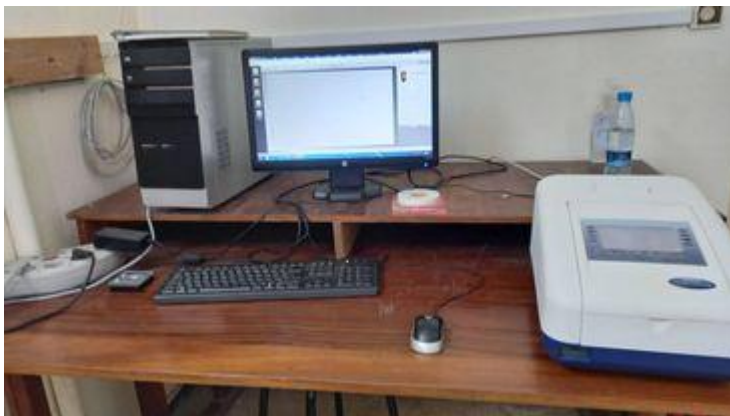
Figure II.3: l'appareil d'UV-visible utilisé pour les mesures de l'absorbance et transmittance
