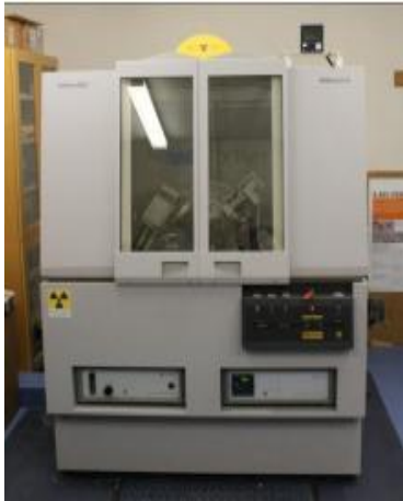
Figure II. 2 : Le diffractomètre XPERT-PRO utilisé pour l'enregistrement de diffractogrammes.
