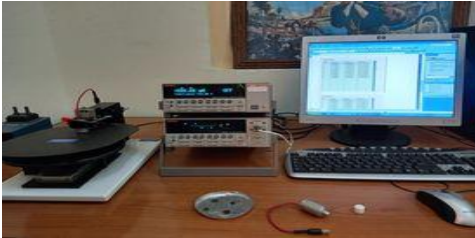
Figure II.5: Dispositif expérimental utilisé pour mesurer la résistivité des spécimens par la méthode de quatre pointes
