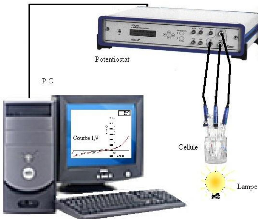
**Fig. II-1** : Dispositif expérimental utilisé pour l'étude photo électrochimique
