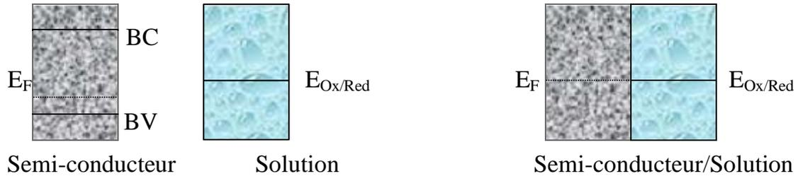
**Fig. I.6** : Formation de jonction entre un SC de type  $p$  et une solution contenant un couple redox dans le noir.
