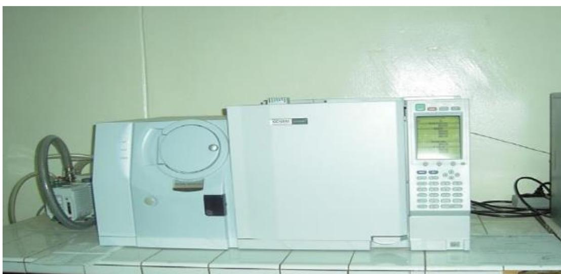
**Figure (22) :** Appareil de chromatographie en phase gazeuse couplée à la spectrophotométrie de masse.
