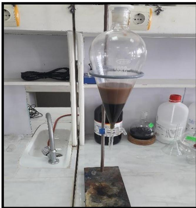
**Figure (14) :** Extraction par solvant (décantation).
