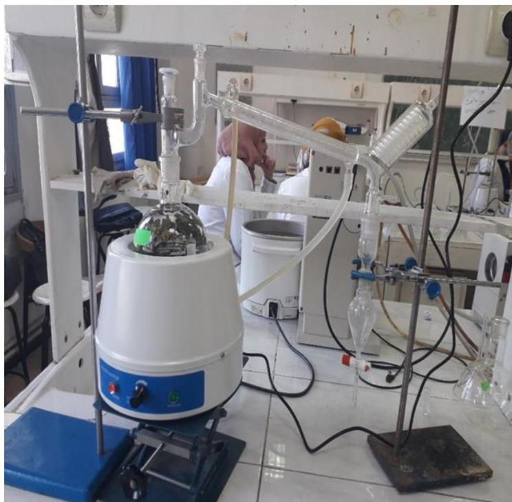
Figure (21) : Montage d'hydrodistillation.
