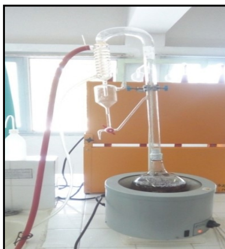
Figure 17 : Dispositif d'extraction des huiles essentielles (Clevenger)
