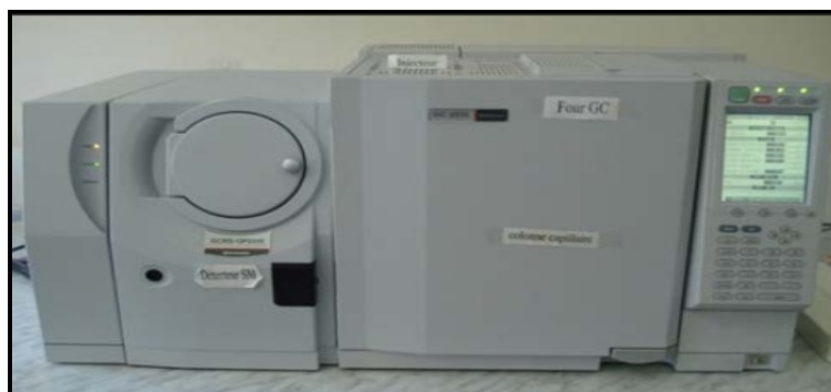
Figure 18: Chromatographe en phase gazeuse couplé à la masse (CPG/SM)
