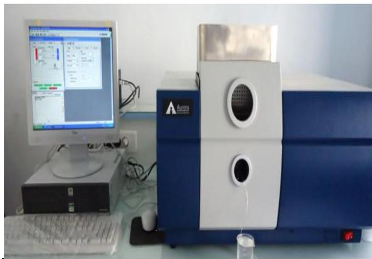
**Photo 05** : L'appareil spectrométrie d'absorption atomique de marque Aurora Instruments AL1200 (**Bendada et Boulekradech 2011**)
