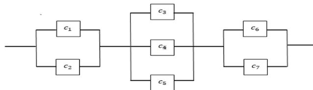
FIGURE 2.4 – Système parallèle-série
