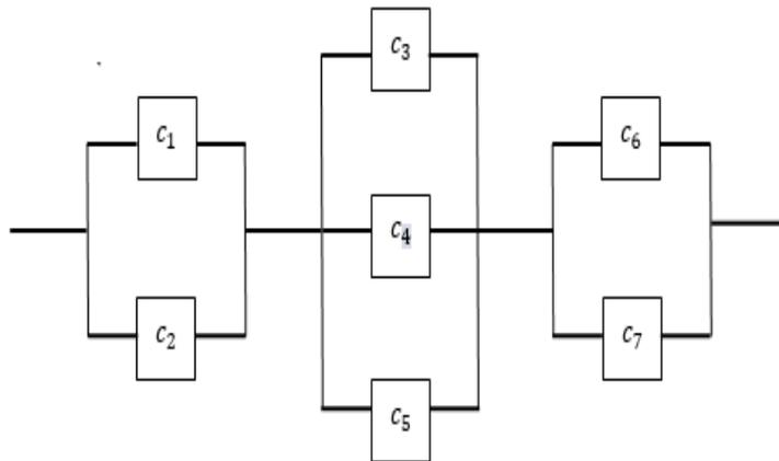
FIGURE 2.1 – Système parallèle-série
