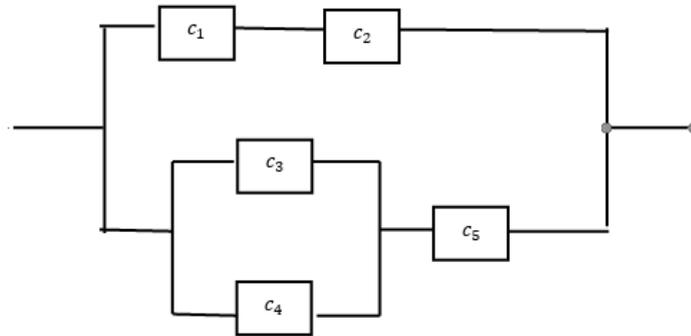
FIGURE 2.7 – Système parallèle-série
