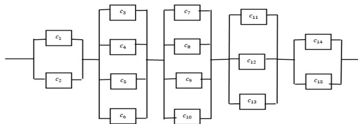
FIGURE 2.13 – Système parallèle-série
