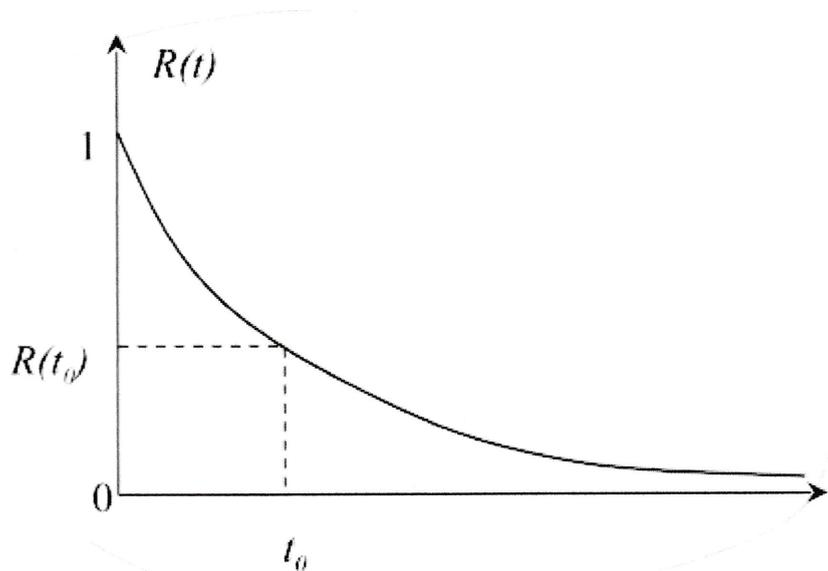
FIGURE 1.1 – Courbe de la fonction de fiabilité
