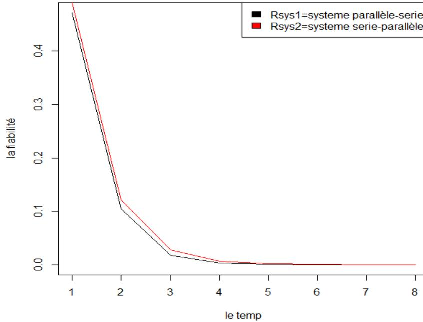
FIGURE 2.3 – Comparaison entre le système série-parallèle et parallèle -série comparaison 4
