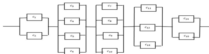
FIGURE 2.10 – Système parallèle-série
