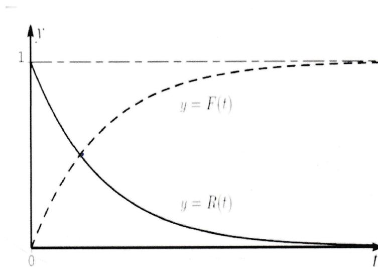
FIGURE 1.3 – Relation entre la fonction de défaillance  $F(t)$  et la fonction de fiabilité  $R(t)$
