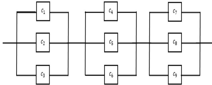
FIGURE 2.16 – Système parallèle-série
