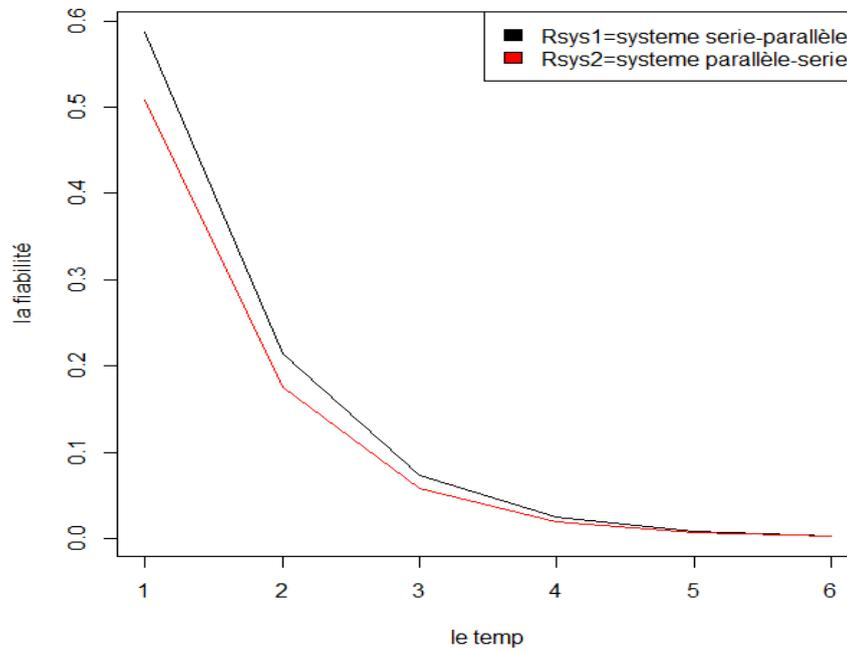
FIGURE 2.9 – Comparaison entre le système série-parallèle et parallèle -série comparaison 6
