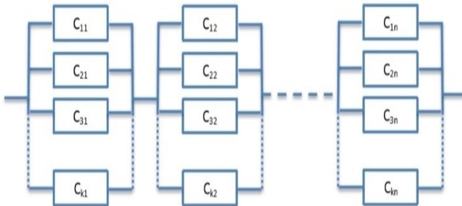
FIGURE 1.9 – Système parallèle-série
