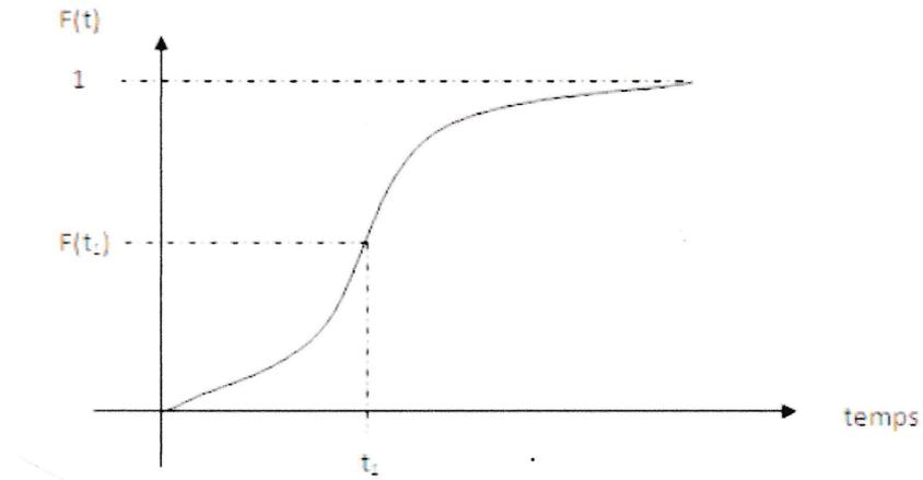
FIGURE 1.2 – Courbe de fonction de défaillances
