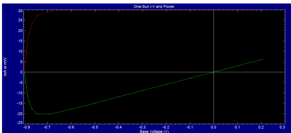
Figure III.2 : Caractéristique courant-tension et courbe de puissance
