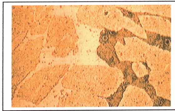
Figure (I.11) : Métallographie d'une corrosion sélective d'un laiton [10].
