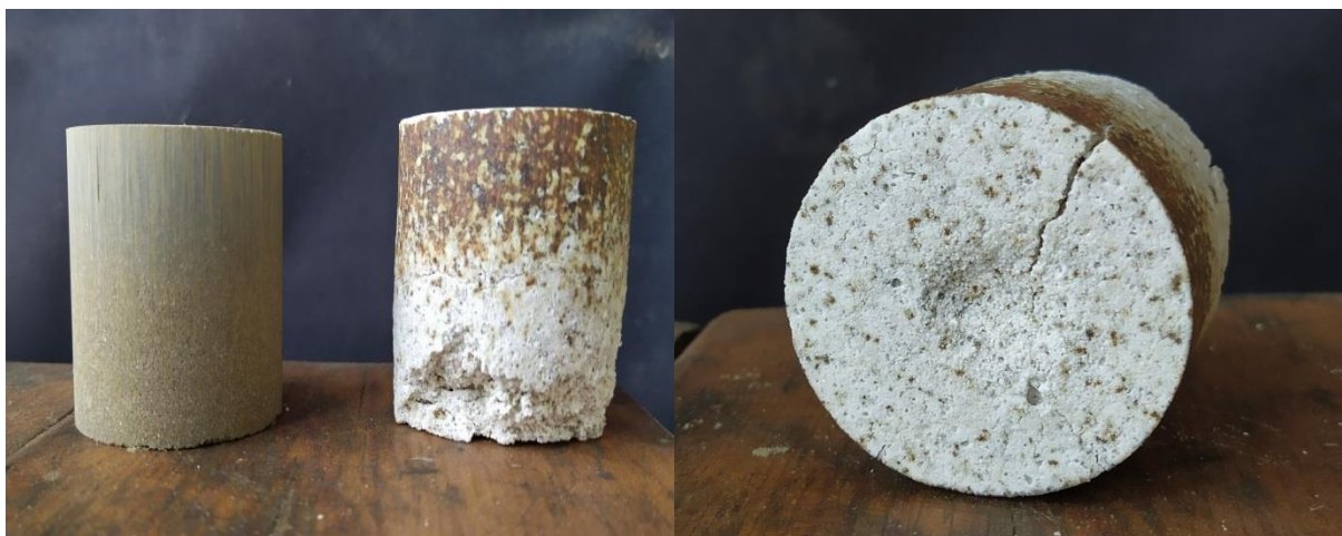
Figure II.16 : Eprouvette KSR avant et après cuisson.
