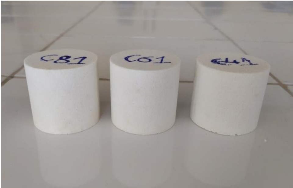
Figure II.20 : Epreuves après cuisson du mélange CJMA.
