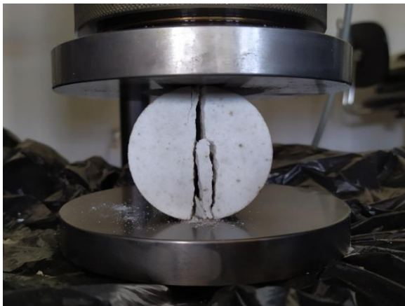
Figure III.6 : Mode de traction (essai brésilien).
