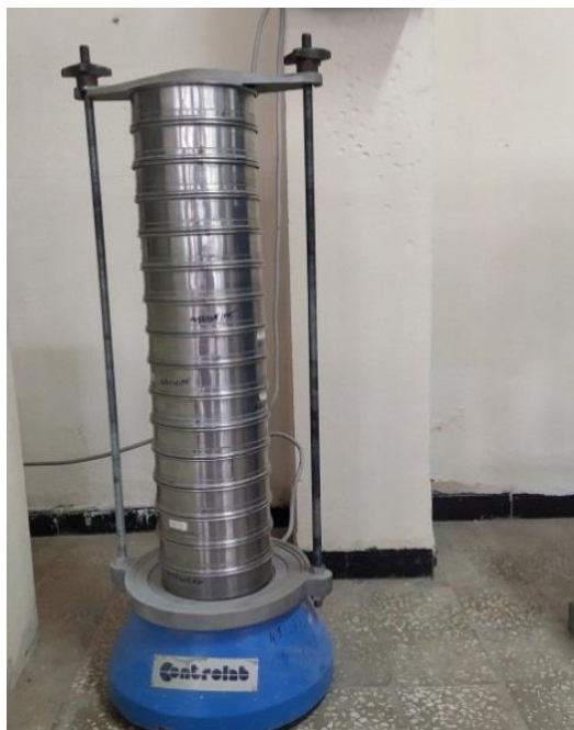
Figure II.7 : Dispositif de tamisage du sable avec 15 tamis.
