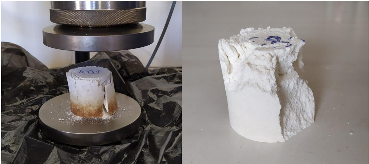
Figure III.2 : Mode écrasement des éprouvettes.
