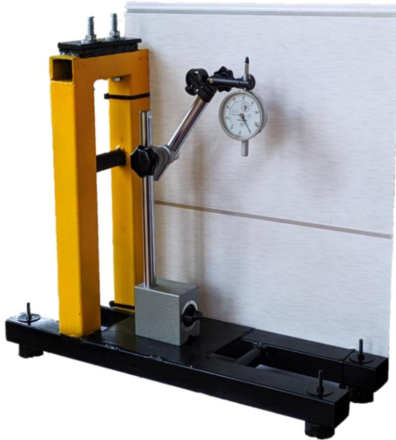
Figure III. 7 : Machine d'essai de fluage.
