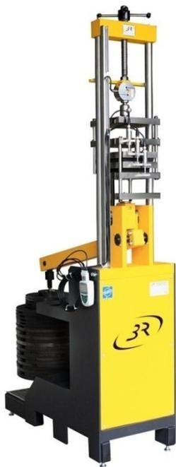
(A) Machine de fluage de type mécanique
