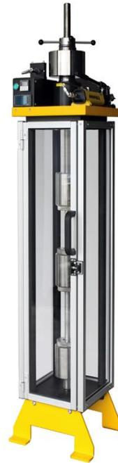
(B) Machine de fluage de type hydraulique
