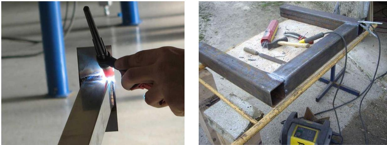
**Figure III. 6 : Soudage des tubes carrés.**
