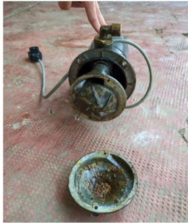
**Figure II.5 :** Pompe de lubrification démontée.
