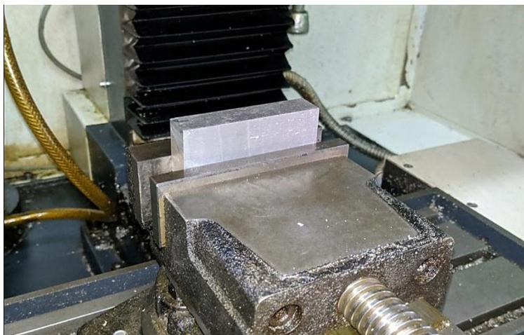
**Figure IV.11** : Fixation du brut de la 1<sup>ère</sup> pièce.
