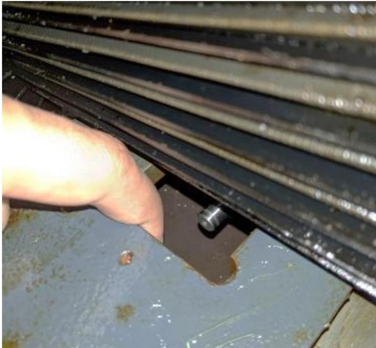
**Figure II.4:** Déblocage du capteur de fin de course de l'axe Y.
