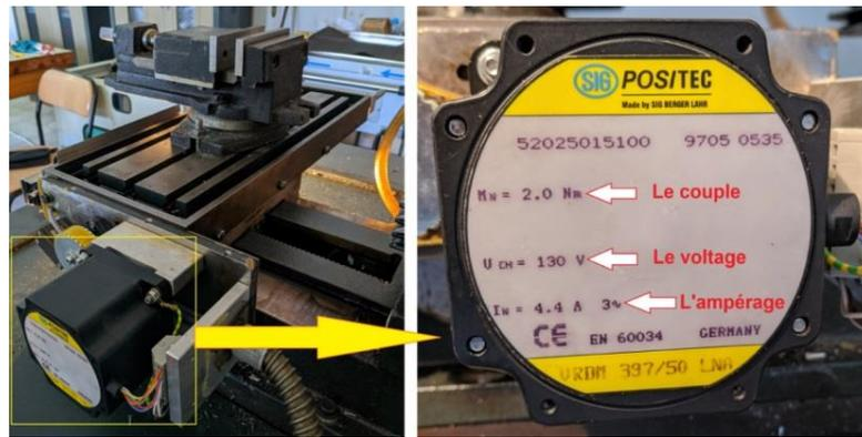
Figure I.15 : Moteur pas à pas de l'axe X
