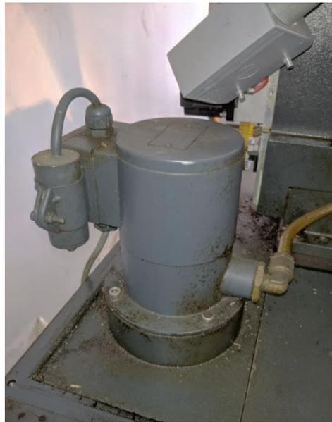
Figure I.26 : Pompe de lubrification (type 3COA2).
