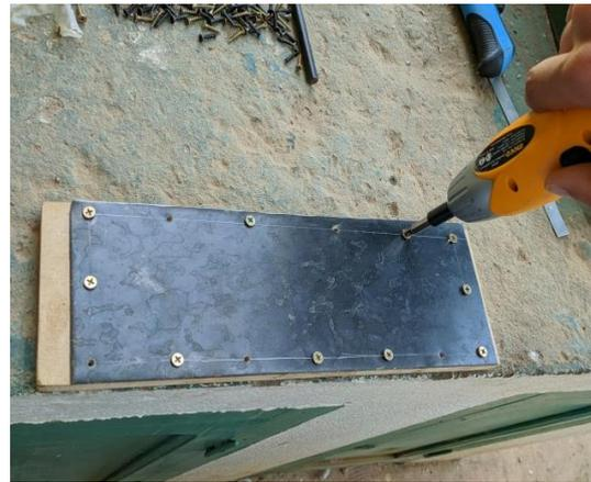
**Figure IV.19 :** Fixation par vis du brut sur une plaque en bois.
