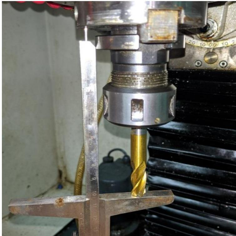
**Figure IV.12 :** Méthode de mesure de la longueur de l'outil.
