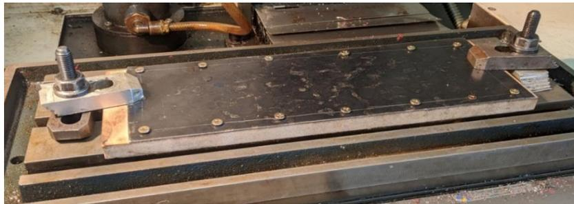
**Figure IV.20 :** Montage de la tôle sur la table de la fraiseuse.
