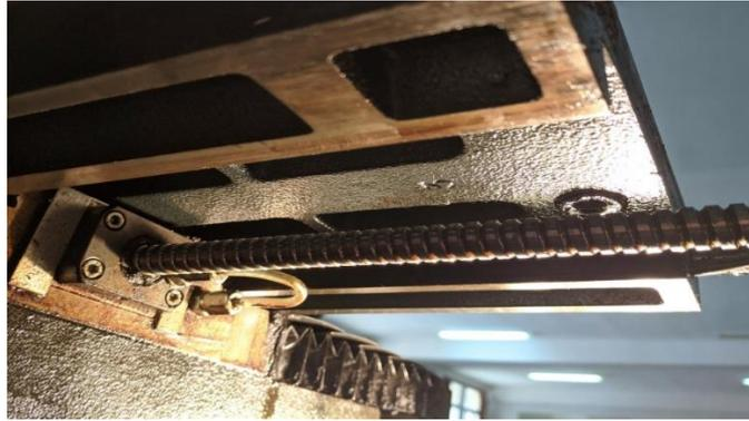
**Figure I.19 :** Système vis-écrou à billes de l'axe X de la fraiseuse Wabeco CC-F.
