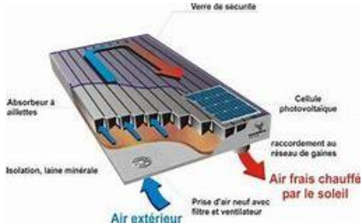
Figure I.4: Capteur solaire à air [5].
