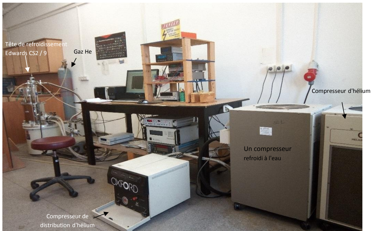
Figure III-7 : Cryostat de mesure de la résistivité électrique en fonction de la température du laboratoire des mesures électrique de l'Université AIB-Bolu, Turquie.
