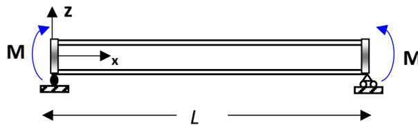
**Figure 5.9:** Poutre à section transversale bi-symétrique sollicitée par deux moments égaux.
